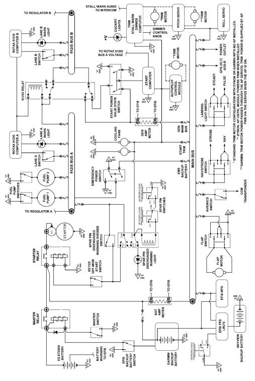
FIGURE 7-7 ROTAX 912 iS ELECTRICAL SYSTEM
