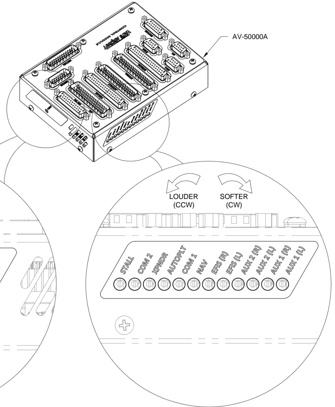
**FIGURE 1: CONTROL MODULE SETTINGS**
